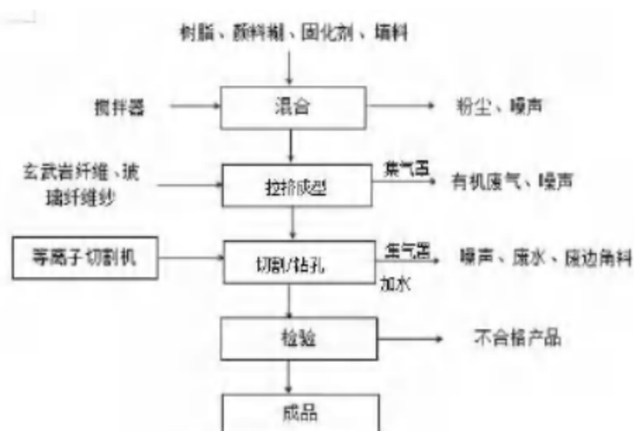
图 2-10 玄武岩复合装配式厕所生产工艺流程及产污环节图
