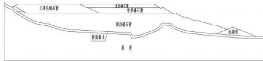
图4-2 A-A 断面堆场运行至堆积终了高程计算简图
